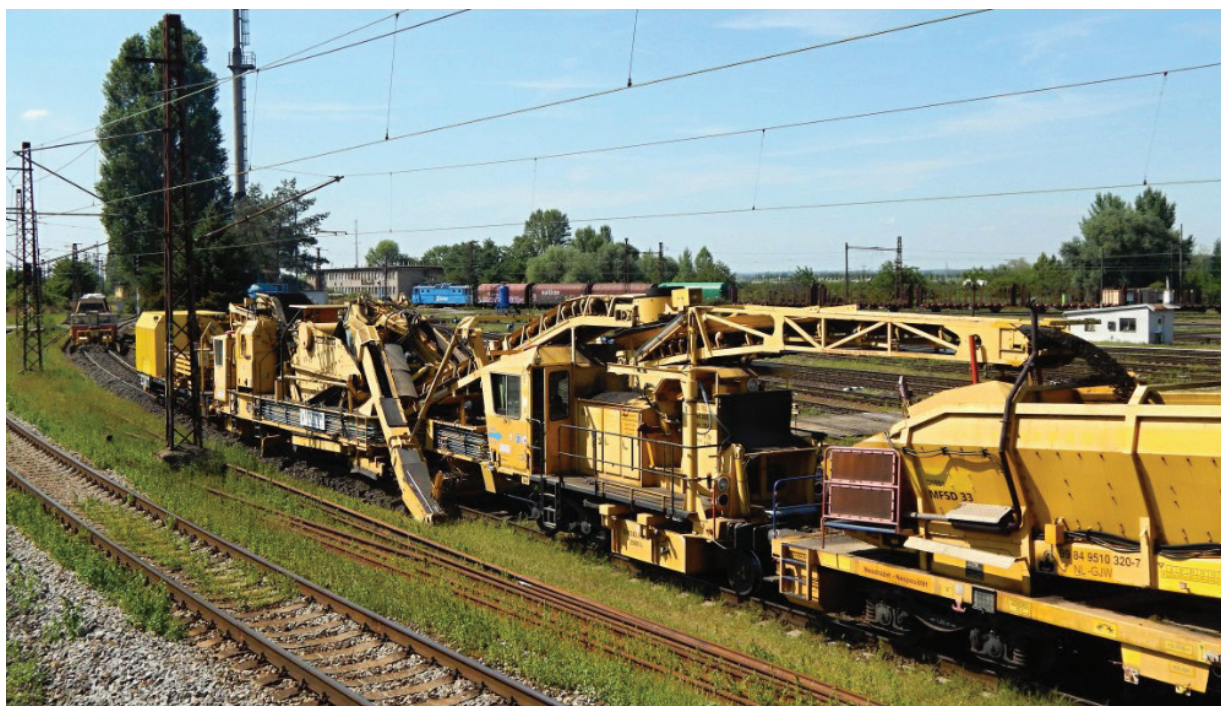
Linka pro čištění kameniva – strojní čistička s velkoobjemovými vozy MFS, doplněná pluhem pro úpravu kolejového lože (Pušl) a automatickou strojní podbíječkou
